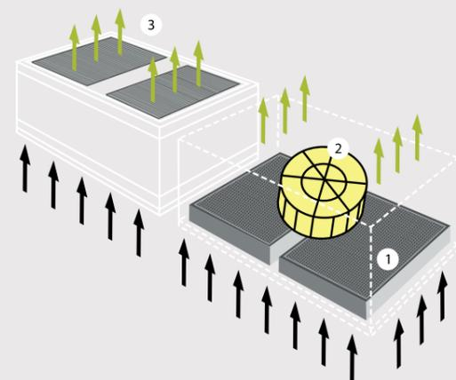
L'aria ambiente, aspirata dal motoventilatore radiale (2), passa attraverso i due carbofiltri (1) collocati sul pannello inferiore, venendo così abbattuto l'inquinante chimico. L'aria filtrata viene quindi inviata nel condotto di espulsione (3) posizionato sulla superficie opposta a quella dei filtri. L'aria in uscita si muove in direzione verticale.
