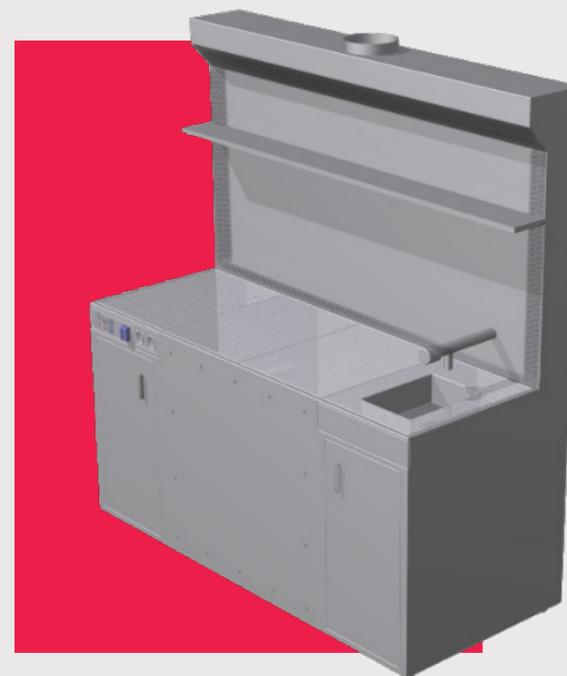
Struttura completamente in acciaio inox AISI 304L con piano di lavoro costituito da una vasca liscia con perimetro rialzato di 40 mm per evitare fuoriuscite di liquidi con incastrati segmenti forellinati facilmente asportabili per pulizia e/o autoclavazione.
