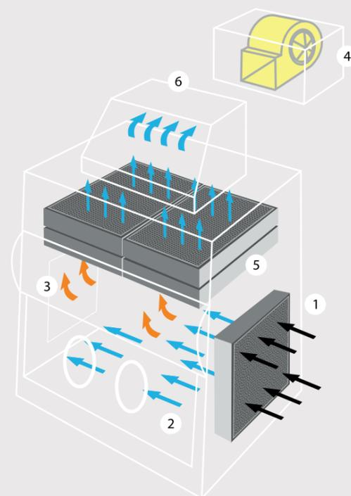
L'aria ambiente entra dal fianco destro della cabina previa sterilizzazione mediante filtro assoluto HEPA (1). Attraversa quindi tutta la camera di lavoro (2) investendo il piano di acciaio. L'aria contaminata (3), aspirata da un motoventilatore esterno (4) che mantiene una pressione negativa all'interno della cappa, viene decontaminata passando attraverso un doppio strato di filtri ULPA (5). L'aria pulita (6) viene convogliata all'esterno dello stabile mediante tubazione sigillata.
