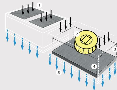
L'aria ambiente, aspirata attraverso i due prefiltri (1) collocati sul pannello superiore, viene convogliata dal motoventilatore radiale interno (2) nel plenum (3) che consente una distribuzione omogenea dell'aria garantendo quindi una pressione bilanciata sul filtro HEPA (4). L'aria in uscita (5) avrà velocità costante e sarà uniformemente distribuita. Il flusso laminare sterile in uscita, in base all'installazione del modulo, può essere verticale od orizzontale.
