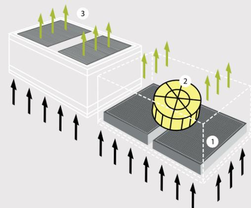
L'aria ambiente, aspirata dal motoventilatore radiale (2), passa attraverso i due carboni (1) collocati sul pannello inferiore, venendo così abbattuto l'inquinante chimico. L'aria filtrata viene quindi inviata nel condotto di espulsione (3) posizionato sulla superficie opposta a quella dei filtri. L'aria in uscita si muove in direzione verticale.
